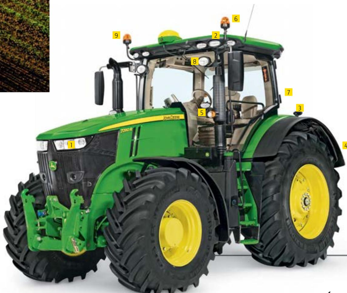
**LOS FAROS DE TRABAJO ESTÁN INTEGRADOS EN LA PARTE DELANTERA, TRASERA Y EN EL TECHO PARA EVITAR POSIBLES DAÑOS PRODUCIDOS POR RAMAS BAJAS.**
